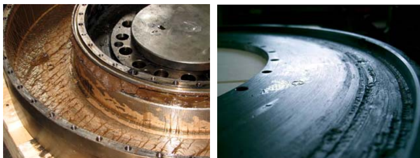
Fotografia 1, 2: Uszkodzone powierzchnie obudowy tłumika
