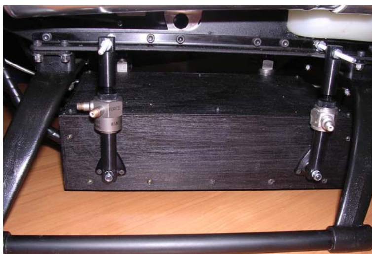
Rysunek 4: Moduł sterujący z czujnikami siły w zawieszeniu
