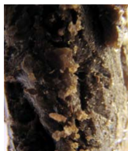
Fotografia 4: Zużyty olej silikonowy – ciało stałe
