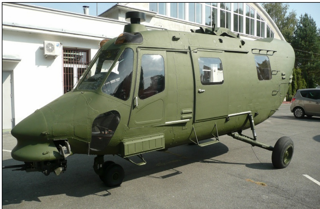
Demonstrator technologii w zakresie systemu najełmowego sterowania uzbrojeniem śmigłowca W-3PL Głuszc z najełmowym systemem celowniczym NSC-1 Orion
